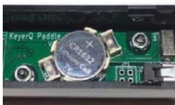
図1 電池セット電池着脱方法
